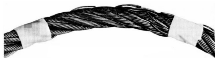
Figura 3: Piegare la fune può spesso esporre i fili rotti nascosti tra i trefoli (fonte: ISO 4309)
